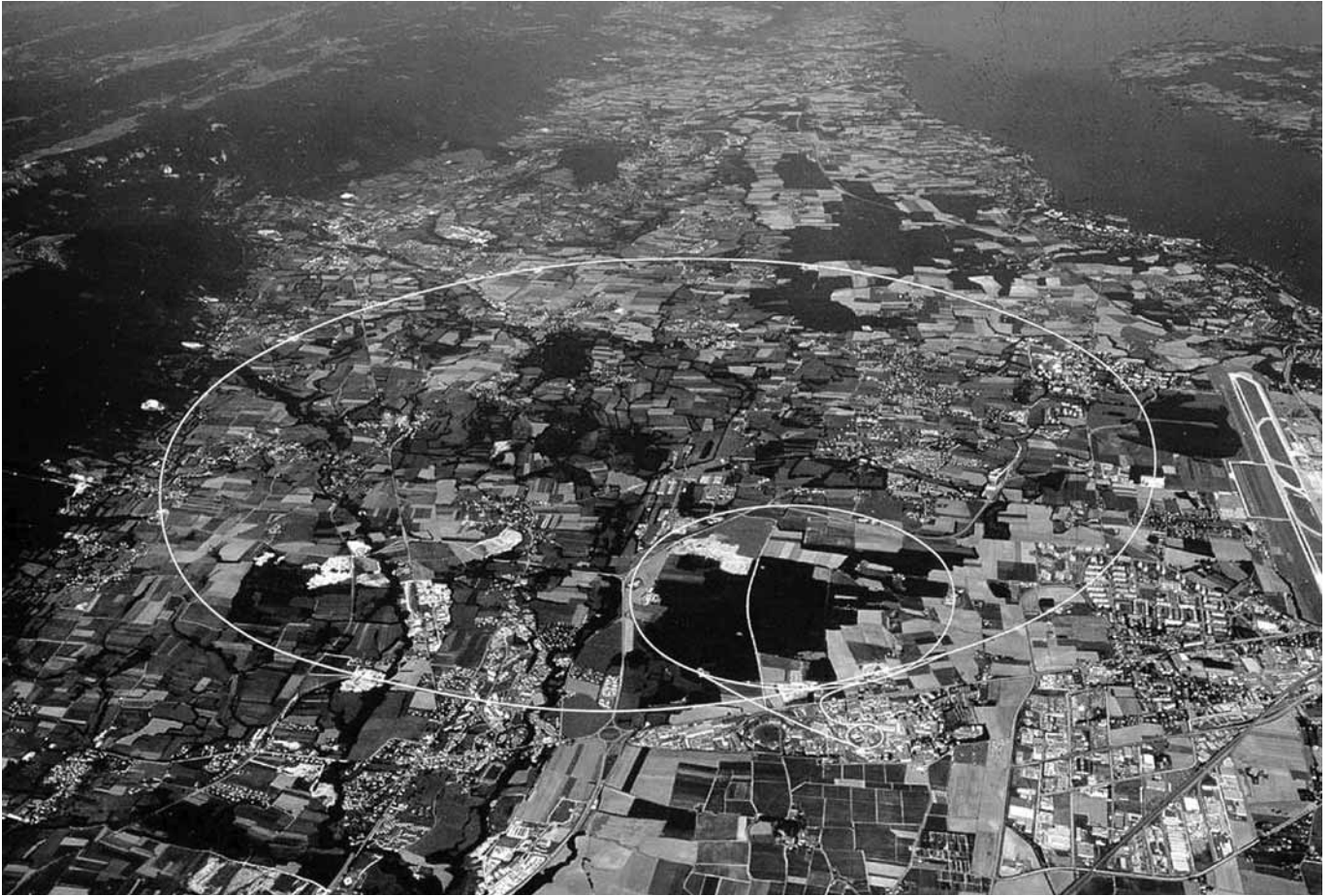
Diagrama del acelerador de partículas LHC, de 27km de perímetro circular, ubicado a un centenar de metros de profundidad en Ginebra, Suiza.
