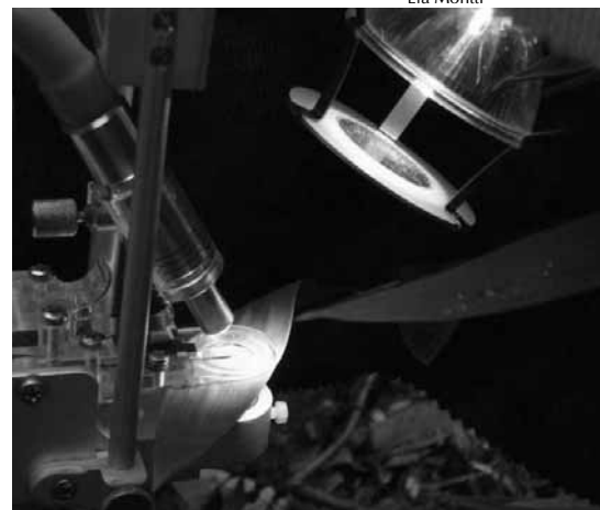
Equipo de cinética de fluorescencia modulada (MiniPaM)
