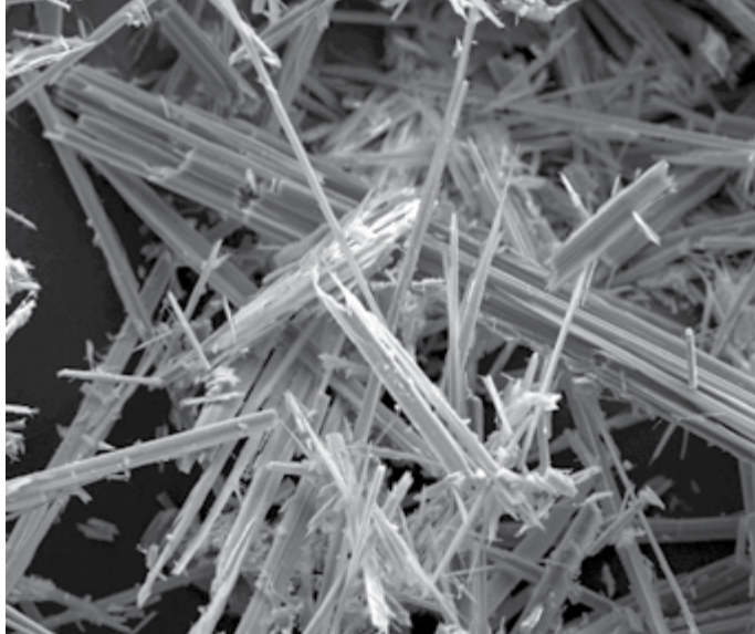
Fibras de amianto vistas con un microscopio electrónico. Foto: United States Geological Survey.
