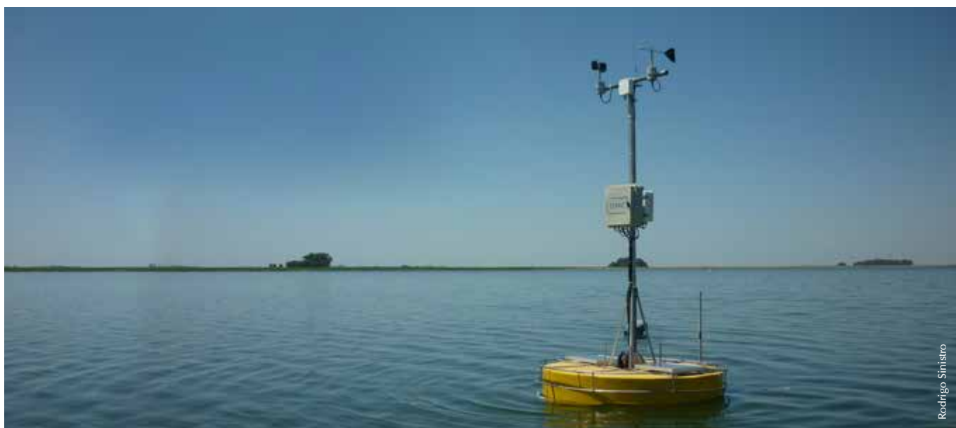
Boya en la laguna de Otamendi con sensores meteorológicos y ambientales que envían información en tiempo real a un servidor del Proyecto Argentino de Monitoreo y Prospección de Ambientes Acuáticos.
