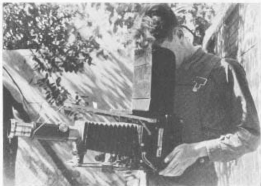
Fig. 2. — Cámara "Erasmiana" de triple tiraje y enfoque de espejo equipada con teleobjetivo "Gillmer" parafocalizado de foco variable y sistema de sustentación para trabajos sin trípoda.
