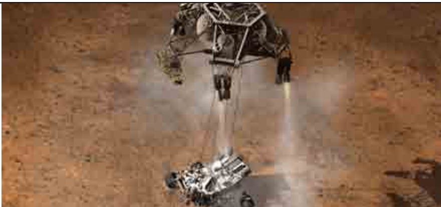
“Nunca se había utilizado el sistema de grúa pero en esta ocasión era necesario porque el vehículo era mucho mayor y más pesado que los prototipos anteriores”, explica Miguel San Martín, el ingeniero que desarrolló el sistema de descenso del Curiosity. Y agrega, “se trató del aterrizaje automático más fino hecho hasta el momento”.
