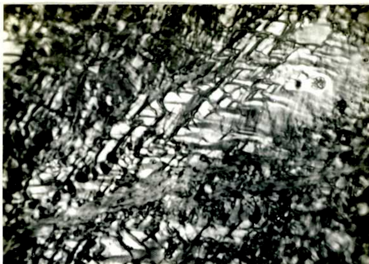
Figure No.20: Pulido Pruna. Material X laminado 75% en frío. Recocido 5 hs 300°C. Deformación por tracción. Obsérvese la de formación de las bandas restauradas.
