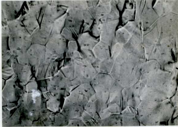
Figura No.57: Pulido Pruna. Luz oblicua. Detalle de la deformación de la estructura de 24 hs 600°C
