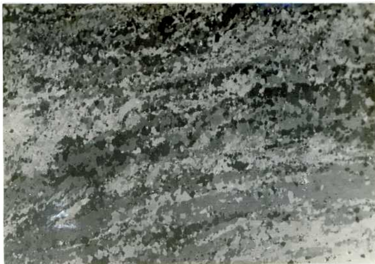
Figura No.31: Pulido Pruna - luz polarizada - 95% recristalización. Material X recocido 1 h. 400°C.
