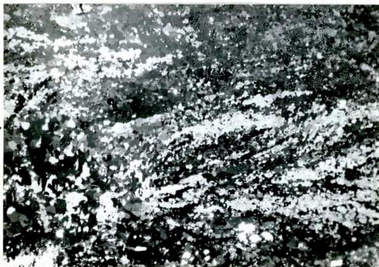
Figura No.24: Pulido Pruna - Luz polarizada. Material X recocido 48 hs 350°C. Obsérvese el crecimiento de grano en las zonas A y B.
