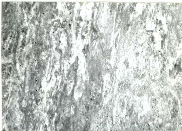
Figura No.14: Pulido Pruna. Luz polarizada Laminado con reducción del 75% en frío.
