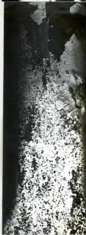
Figura No.60: Grabado Robillard. Oxidación atmosférica. Recristalización por deformación crítica en una microprobeta de tracción.
