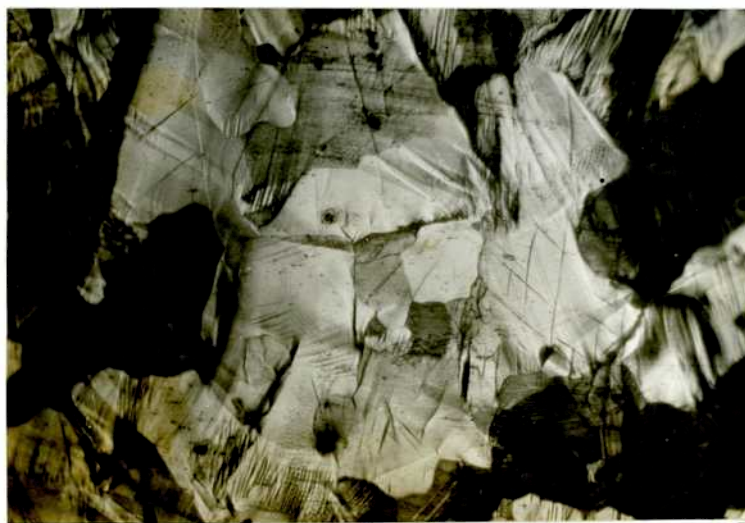
Figura No.18: Pulido Pruna. Luz oblicua. Idem que Figura 17 luego de la tracción.
