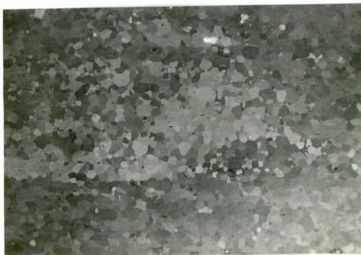
Figura No.55: Pulido Pruna. Luz polarizada. Material Y recocido 150 hs 350°C. Obsérvese el bandeado.
