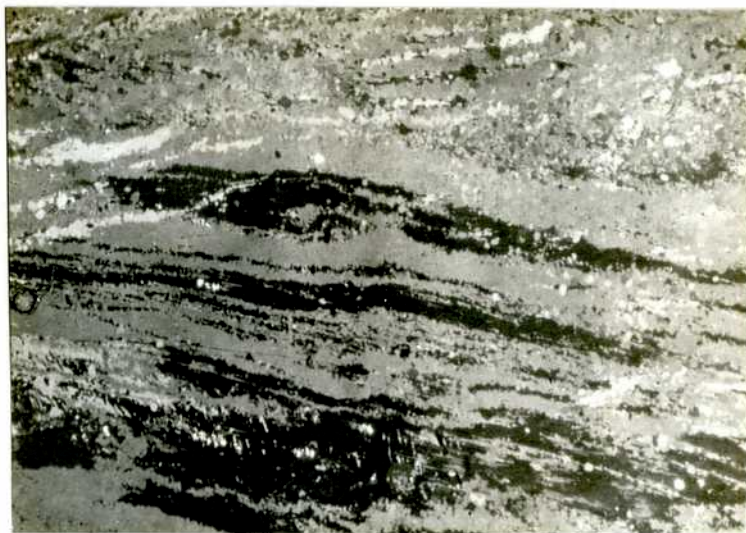
Figura No.23: Pulido Pruna - Luz polarizada. Material X recocido 5 hs 350°C. Estructura parcialmente recristalizada.
