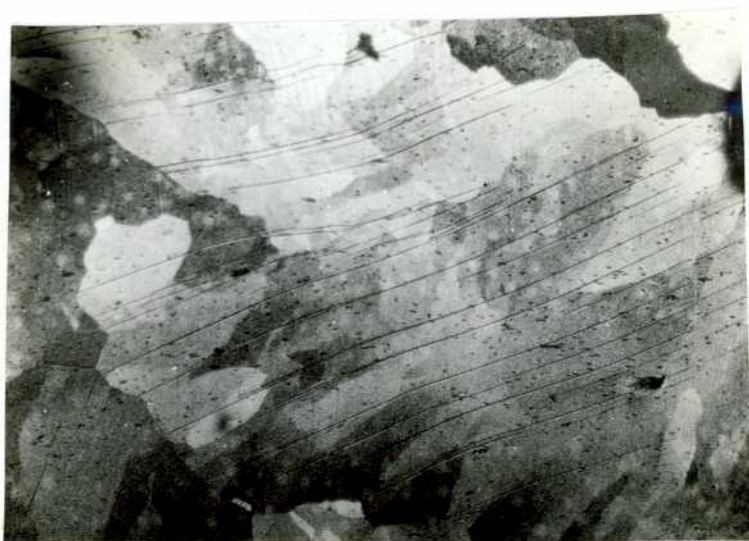
Figura No.64: Grabado Robillard - oxidación atmosférica. Estructura de cambio de fase
