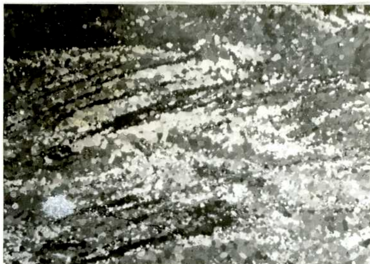
Figura No.29: Pulido Pruna - luz polarizada - Material X recocido 5 hs 380^{\circ}\text{C}
