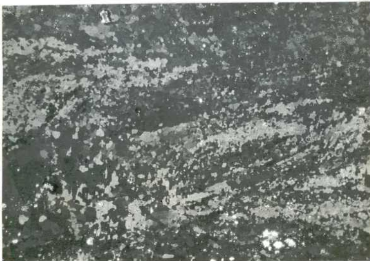
150x Figura No.49: Pulido Pruna. Luz polari- zada. Material Y recocido 48 hs 350°C.
