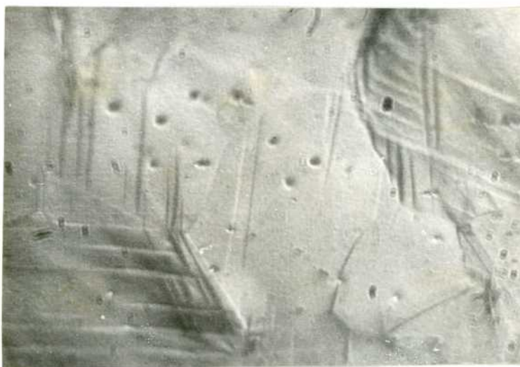
Figura No.43: Material X recocido 24 hs 600°C (V). Deformación por tracción.
