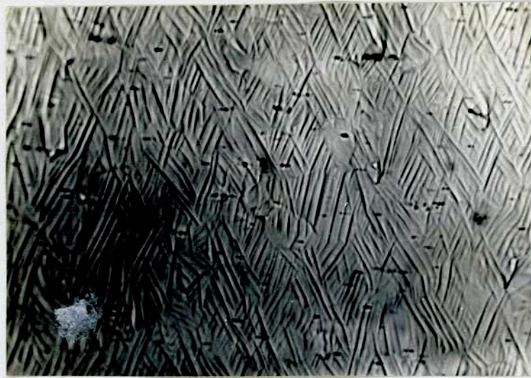
Figura No.39: Material X recocido 1' 600°C Deformación por tracción de una banda.
