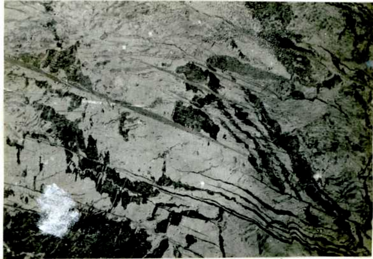
Figura No.44: Pulido Pruna. Luz polarizada. Estructura de laminación. Material Y laminado 80% en frío.
