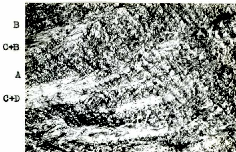
Figura No.25: Pulido Pruna. Estructura de la deformación por tracción de material X recocido 48 hs 350°C.
