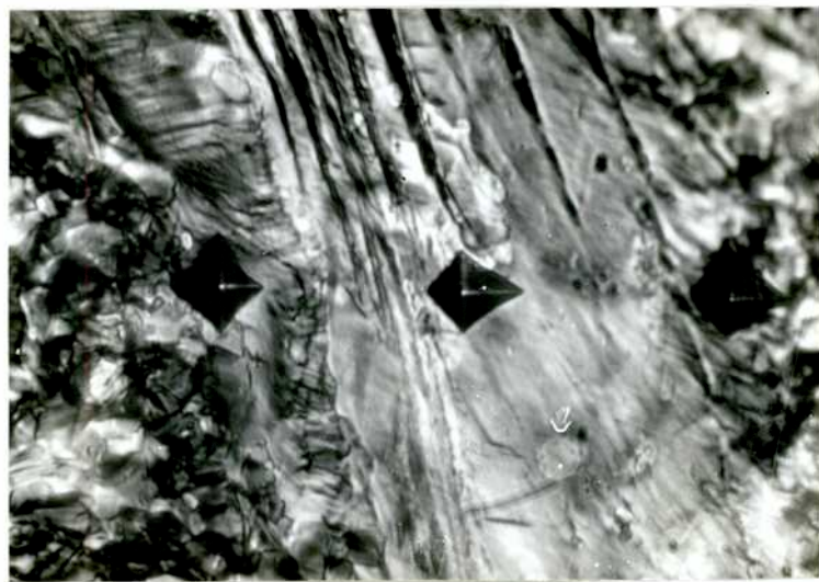
Figura No.28: Pulido Pruna. Improntas de microdureza en banda restaurada y recristalizada.
