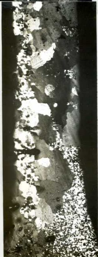
Figura No.59: Grabado Robillard. Oxidación atmosférica. Recristalización total en una microprobeta de tracción.
