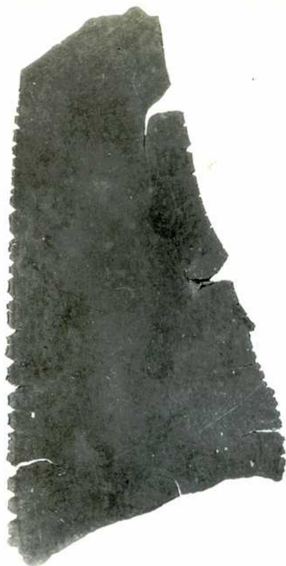
Figura No.10: Uranio alemán 1x laminado por método Fisher, 20% de reducción en frío.
