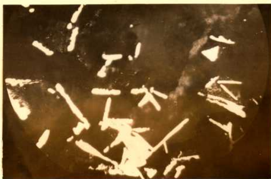
Fotografía 11: inmersión en aceite; X 200 Tablillas de calcopirita en calcita (gris)
