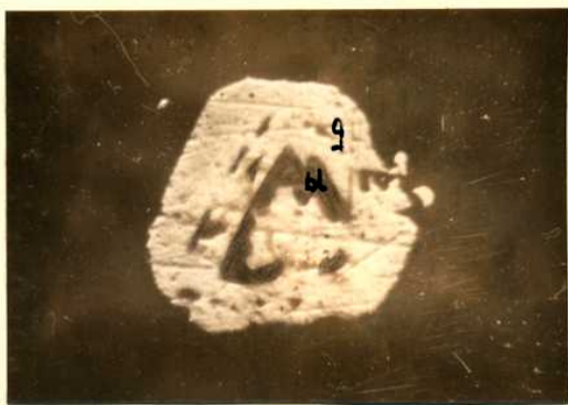
Fotografía 10: inmersión en aceite; X 400 Galena (g) reemplazando pseudomórficamente a blenda (bl) de la que quedan relictos.
