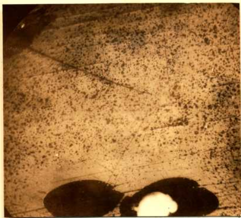
Fotografía 3 : inmersión en aceite, X 150. "Desmezcla" de dos asfaltos (gris mediano y gris oscuro) del tipo B.
