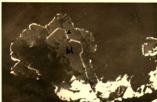
Fotografía 6: inmersión en aceite; X 200. Calcopirita (c) intercrecida con blenda (bl)
