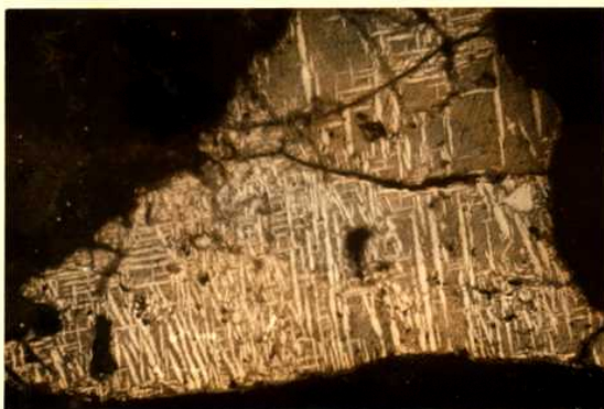
Fotografía 16: inmersión en aceite; X 100 Bornita con desmezclas de calcopirita; estado muy avanzado
