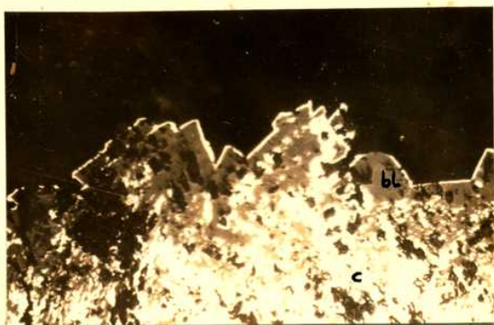
Fotografía 7: inmersión en aceite; X 200. Blenda (bl) intercrecida con calcopirita (c), y además reemplazada por ella.
