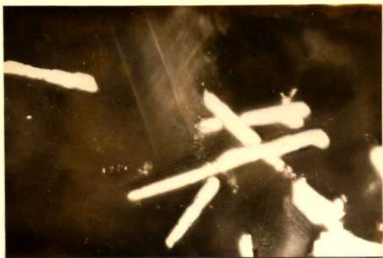
Fotografía 13: inmersión en aceite; X 400 Tablillas de calcopirita en calcita, de la que se observan maclas y reflejos internos
