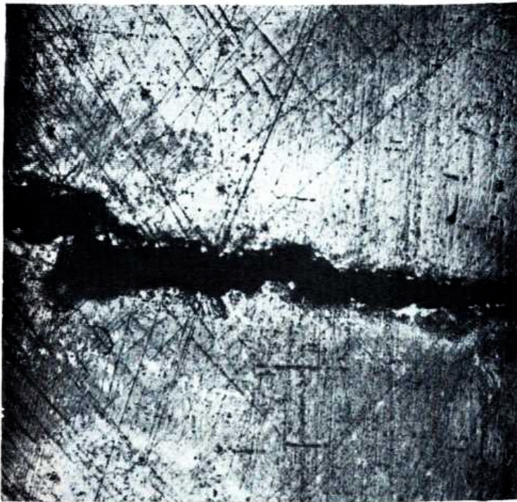
Fig. 34: Idem Fig. 33. Fractura producida a un potencial de electrodo de -0,71 V_H (35 x)
