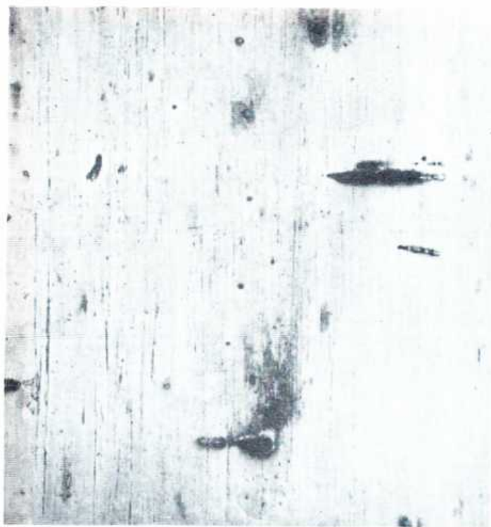
Fig. 26: Acero AISI 4340 austenitizado y revenido a 450°C en solución de cloruro de sodio 0,5 N, 25°C, intensidad anódica constante; 0,5 minutos de exposición (120 x)
