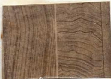
Estructura típica 450x de un depósito de níquel obtenido a partir de un baño brillante
