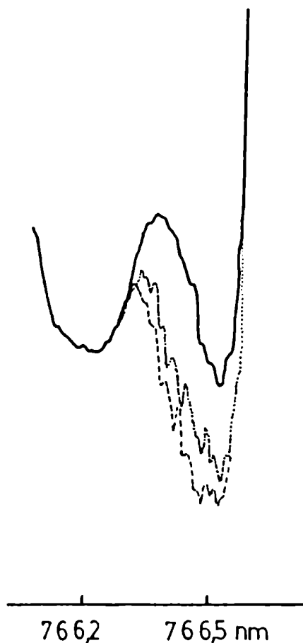
Fig. 7-8: Influencia de la concentración de potasio en el perfil de emisión de molibdeno..... 1 mg K/L; ---- 2 mg K/L. Intensidad de corriente de la fuente: 10 mA, ancho de banda espectral: 0,165 nm, expansión de escala xl, en presencia de 1000 mg Na/L como supresor de ionización.
