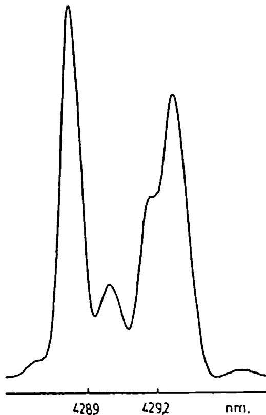
Fig. 6-15: Espectro de emisión de la lámpara de molibdeno en el ámbito de la línea de Ne(II) a 429,04 nm. Ranura 25 \mu m; intensidad de corriente: 4 mA. Mo(I) 428,864; Mo(I) 428,942; Mo(I) 429,018; Ne(II) 429,040; Mo(I) 429,120; Mo(I) 429,213; Mo(I) 429,321 nm (Ref. 112).
