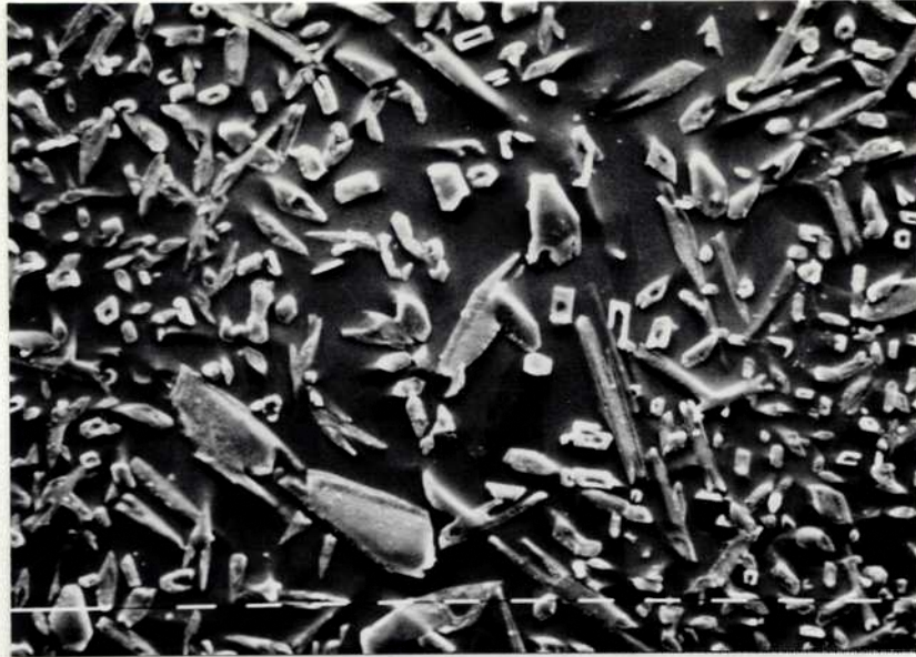
A. Zr-14,9%at Sn, 2 hs a 1713 K, enfriado en horno de alto vacío cortando la potencia. Precipitados de Zr_5Sn_3 en una matriz \beta -transformada.
