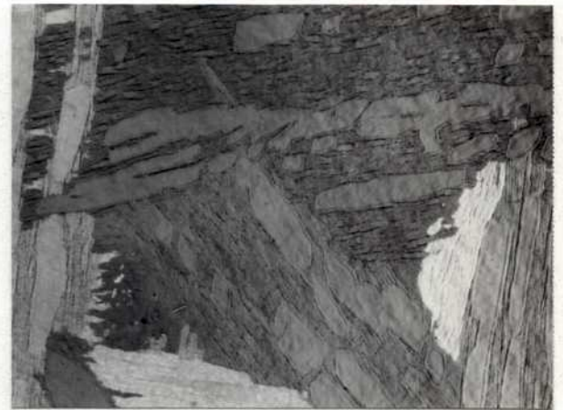
D. Zr-0,5%at Sn(Fe), 170 hs a 1163 K, templado en agua. Placas con bordes lisos (fase \alpha ) dentro de granos con bordes aserrados (fase \beta -transformada). M.Óptica 200X.
