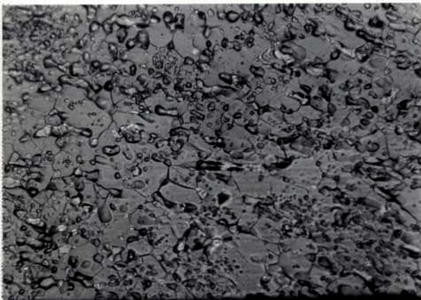
C. Zr-19,4%at Sn, 43 hs a 1423 K, templado en agua sin rotura. Restos de \beta -transformada y Zr_5Sn_3 en una matriz de Zr_4Sn . M.Optica 240X.
