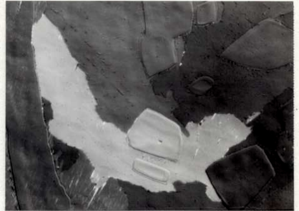
B. Zr-0,5%at Sn, 170 hs a 1163 K, templado en agua. Placas con bordes lisos (fase \alpha ) dentro de granos con bordes aserrados (fase \beta -transformada). M.Óptica 96X.
