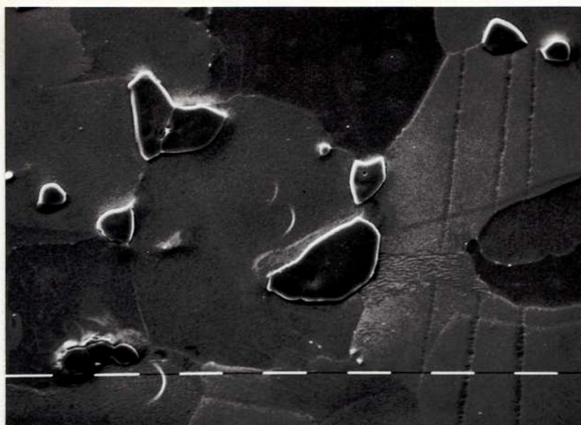
A. Zr-7,1%at Sn, 240 hs a 1243 K, templado en agua. Placas de Zr_4Sn en una matriz formada por granos \alpha y restos de fase \beta -transformada. M. Electrónica, cada rayita \equiv 10\mu m .
