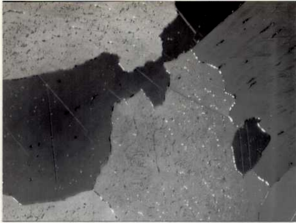
A. Zr-2,4%at Sn, 170 hs a 1163 K, templado en agua. Granos \alpha con bordes lisos. M. Optica 190X.
