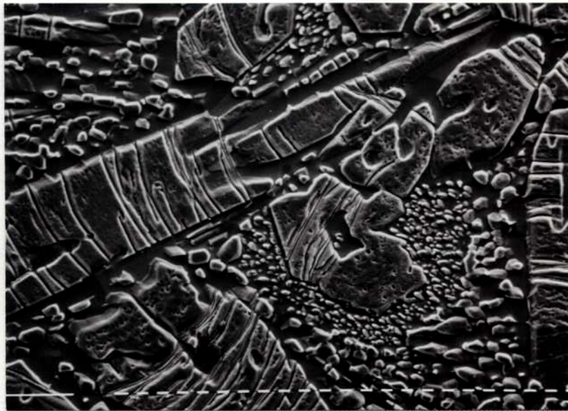
B. Zr-23,8%at Sn, 2 hs a 1713 K, enfriado en horno de alto vacío cortando la potencia. Cristales primarios de Zr_5Sn_3 en una matriz ( \beta -transformada + Zr_5Sn_3 ).
