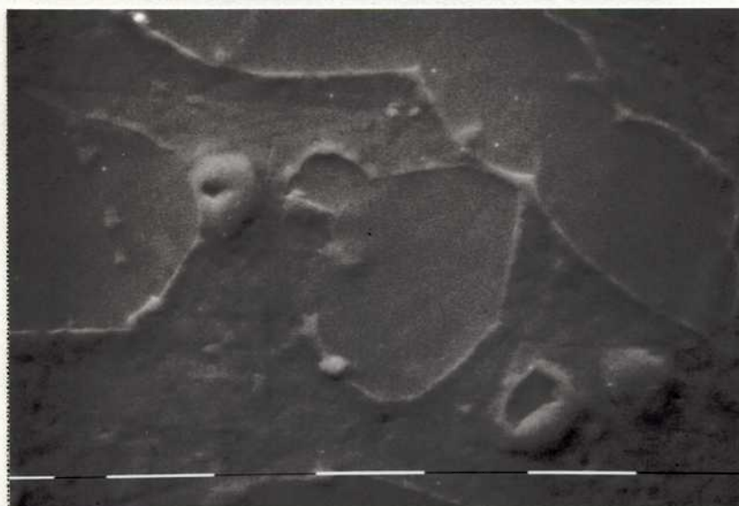
B. Zr-14,9%at Sn, 115 hs a 1493 K. Zr 4 Sn (zona lisa) y \beta -transformada (zona rugosa). Pequeños cristales de Zr 5 Sn 3 en \beta o en la inter- fase \beta /Zr 4 Sn. M.E- lectrónica, cada rayita \equiv 10 \mu m.
