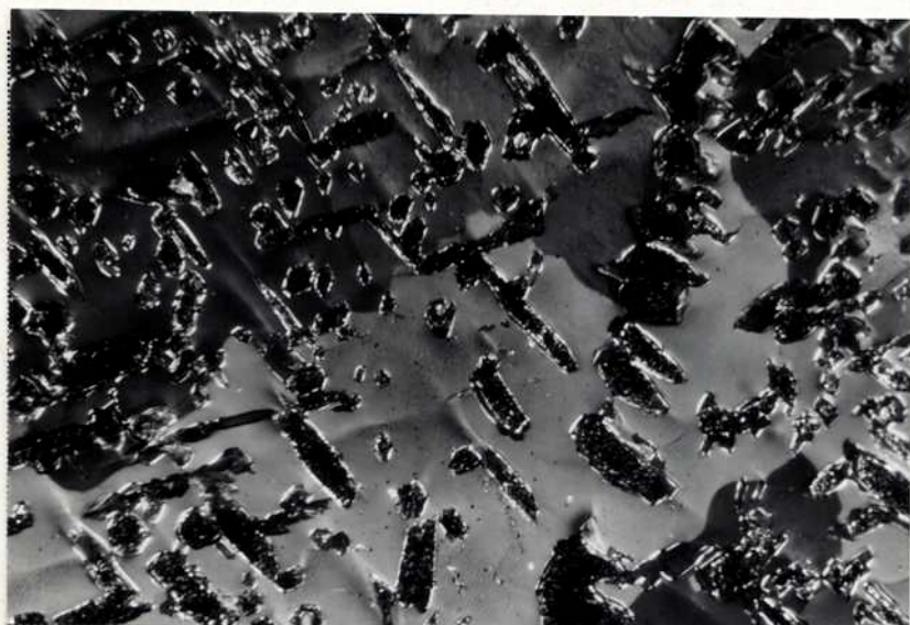
A. Zr-14,9%at Sn, 4 hs a 1713 K, en- friado en horno. Precipitados de Zr_5Sn_3 en una matriz \beta -transformada. M.Optica 500X.
