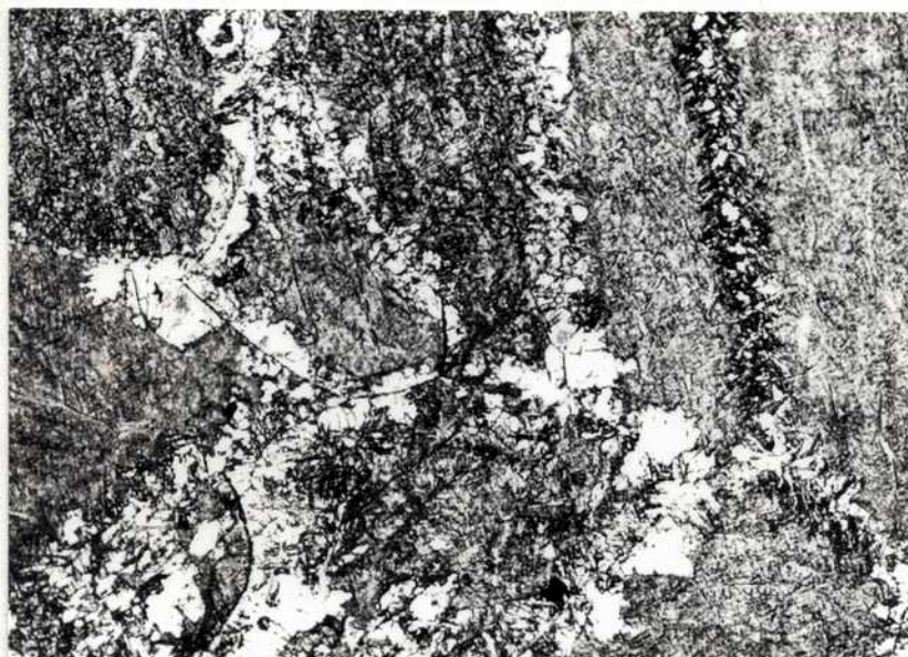
B. Zr-14,9%at Sn, material sin tratamiento térmico. No se observan compuestos intermetálicos. M.Óptica 100X.
