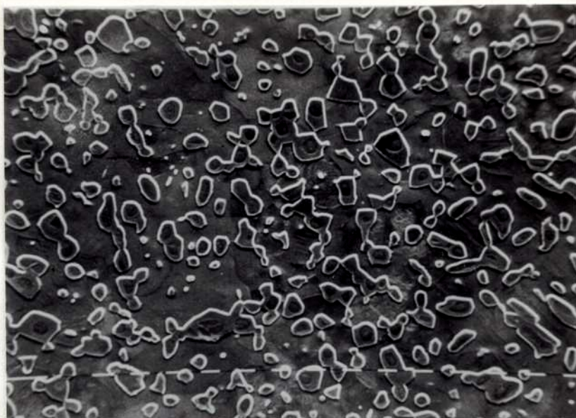
A. Zr-10,8%at Sn, 2½ hs a 1473 K → 235 hs a 1243 K → enfriado en horno hasta 1073 → enfriado al aire. Distribución bastante homogénea de placas de Zr 4 Sn. M. Electrónica, cada rayita ≅ 10µm.
