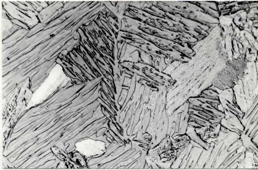
A. Zr-3,3% at Sn, 300 hs a 1193 K, templado en agua. Coexistencia de las fases \alpha y \beta -transformada. M.Optica 100X.
