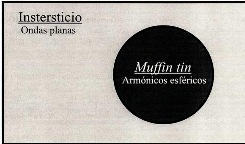
**Figura 2.1:** Zonas en la que se divide el sólido para utilizar los métodos de ondas planas aumentadas.
