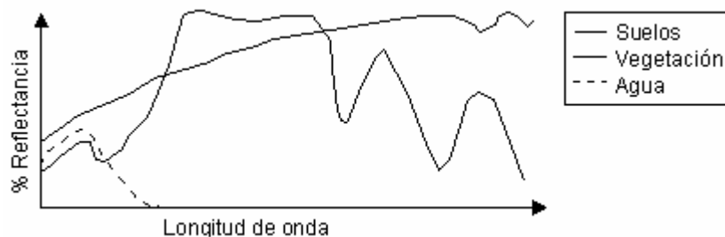
Fig 4.1 Firmas espectrales típicas de distintas cubiertas
