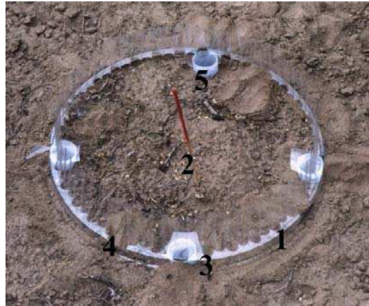
Figura 2.1. Dispositivo semiautomático que consiste en una clausura circular de plástico (1) que rodea la boca del nido (2) con cuatro “entradas” (3) y cuatro “salidas” (4). En el lado interno de cada entrada se colocan recipientes (5) que, al ser abiertos, capturan a las hormigas que vuelven al nido con su carga.
