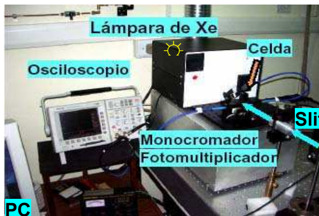
Figura III.12. (A) Esquema del sistema Laser Flash Photolysis: ☀: lámpara de xenón (Xe), MC: monocromador, PM: fotomultiplicador, PC: computadora. (B) Fotografía indicando las distintas partes del sistema.
