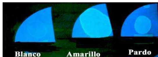
Figura 2.12: Sistema lisina-glucosa- buffer fosfato absorbido en papel de filtro (100 \mu l). Los tres sistemas analizados bajo la fuente de luz (350 nm).
