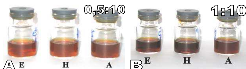
Figura III.9. Fotografías de los extractos obtenidos con diferentes solventes a partir de té. Solventes utilizados: E: etanol/agua (70/30% p/p), 25°C; H: Agua 100°C; A: acetona/agua (70/30% p/p), 25°C. Las relaciones de concentración sólido:solvente (g sólido: mL solvente) fueron 0.5:10 (Figura III.8.A) y 1:10 (Figura III.8.B).
