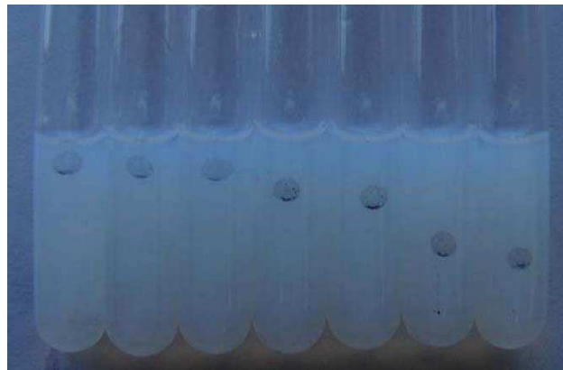
Figura II.11. Foto de los geles sintetizados para evaluar el tiempo característico de difusión de citrato en función de la distancia entre la superficie del monolito de sílica hasta la esfera de alginato. Se inmovilizaron en el alginato de calcio micropartículas de \text{CoFe}_2\text{O}_4 , cuya movilidad frente a un campo magnético externo fue indicio de la licuefacción de la cavidad de alginato.
