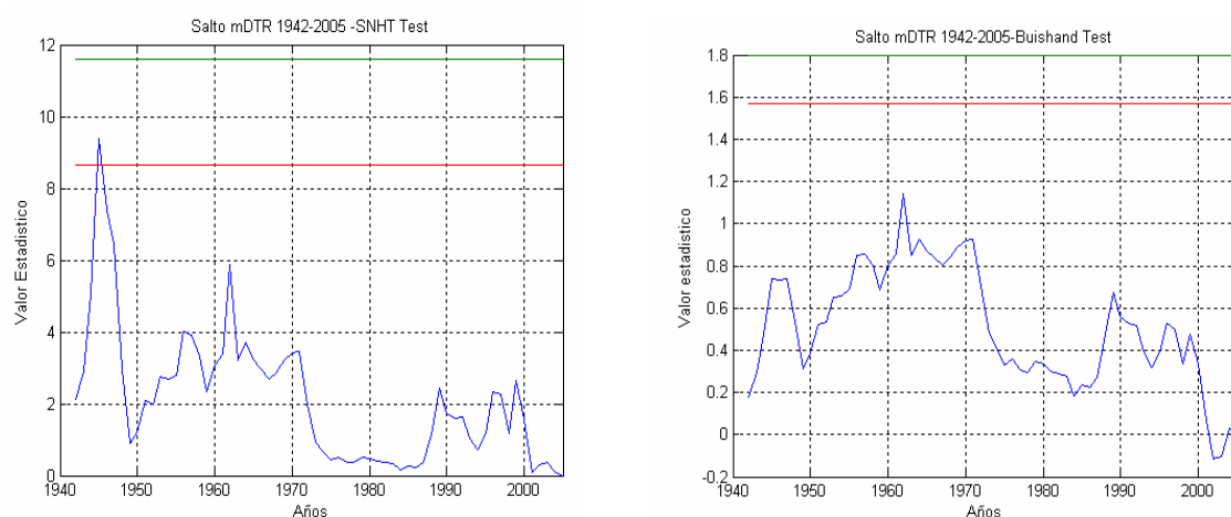
Fig 2.4 Resultado de SNHT test (izquierda) y Buishand (derecha) aplicados a mDTR, Salto. La línea roja el nivel de 5% de significancia y la línea verde el 1%
