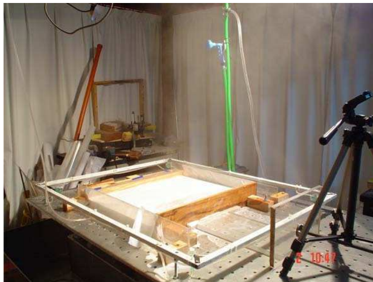
Figura 4.29: Modelo en ejecución. En las esquinas del marco metálico blanco pueden apreciarse los atomizadores responsables de la generación de la microrlluvia.
