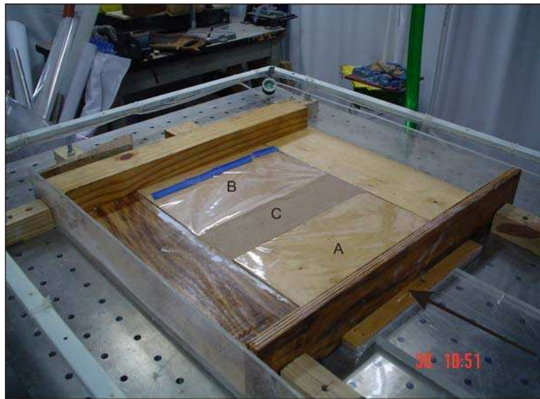
Figura 4.27: Caja de modelado análogo, sistema de deformación. A) Bloque de madera móvil. B) Bloque de madera fijo con diseño de rampa de 30 grados. C) Arcilla de modelado utilizada como material a deformar.
