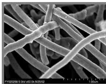
Fig.1.13: Microscopía electrónica de barrido de Nanotubos de carbón 75 .
