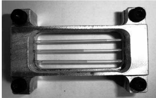
Figura 3.1: Arreglo de tubos capilares: el cátodo fue ubicado en el extremo izquierdo, mientras que el ánodo en el extremo derecho de cada tubo capilar, respectivamente. El color oscuro en los tubos capilares indica el cambio de pH. Cada capilar representa un experimento independiente.
