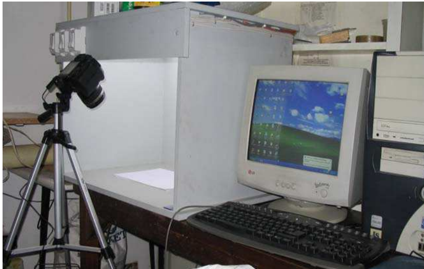
Figura 3-13: Sistema de visión computarizada para la adquisición de imágenes.
