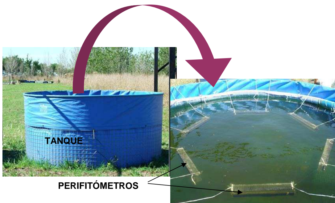
Fig. 4.1. Tanque experimental utilizado para la experiencia. En la foto de la derecha se observan los perifitómetros instalados para la colonización de los sustratos artificiales.
