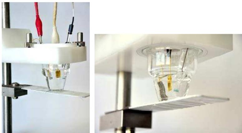
**Figura 3.3:** Imagen de la celda y sistema de electrodos empleados en las medidas electroquímicas.
