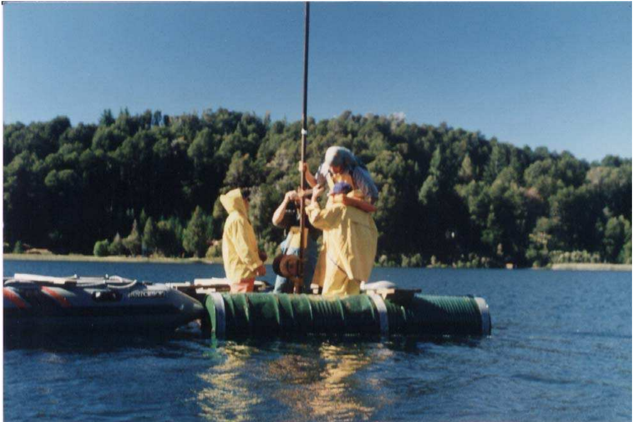
Fig. 20: Hincado del sacatestigo. La balsa es ubicada con ayuda de un bote neumático y anclada al fondo del lago. Un orificio en el centro de la balsa permite las operaciones de extracción en profundidades de aguas de hasta 15 metros de profundidad.
