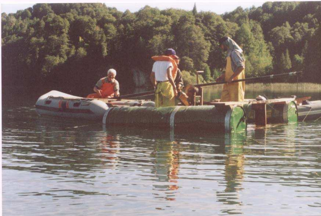
Fig. 21: Extracción del sacatestigo. Una vez hincado el sacatestigo, es posible extraer una columna sedimentaria de hasta dos metros de longitud. La operación se repite entre 5 a 7 veces, hasta atravesar toda la secuencia sedimentaria y encontrar el basamento de la cuenca.
