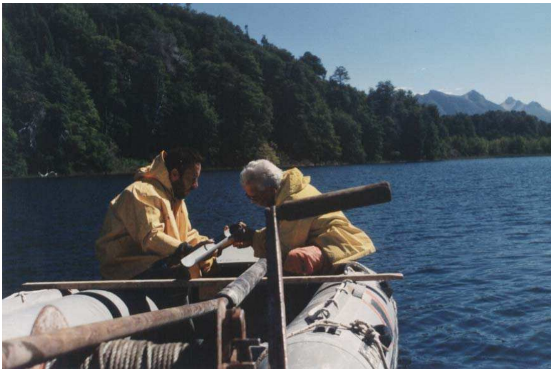
Fig. 22: Extrusión de un tramo de testigo del lago Escondido. Cada columna sedimentaria de hasta 2 m de longitud, es dispuesta en tramos de hasta un metro, sobre tubos de plástico cortados longitudinalmente. Un malacate manual ayuda a extraer en forma controlada, la columna sedimentaria del sacatestigo.
