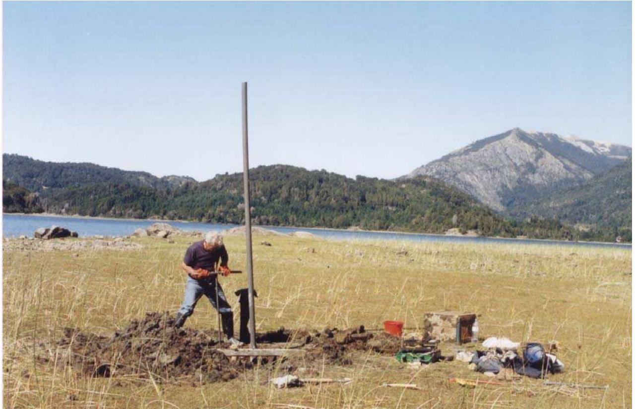
Fig. 17: Obtención de testigos sedimentarios de la secuencia lacustre basal aflorante sobre la costa del lago Moreno. El tubo de PVC, de seis metros de longitud, fue hincado y extraído manualmente.
