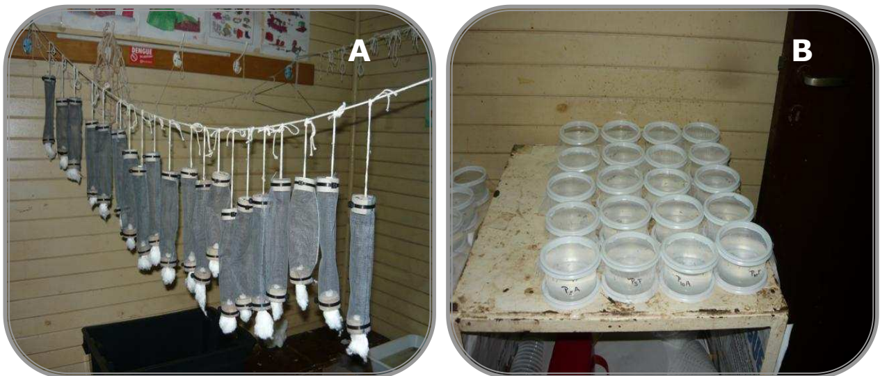
Figura 23. Jaulas centinela (A) y potes de plástico de 250 ml (B) utilizados para evaluar la efectividad de los tratamientos sobre adultos y larvas de Ae. aegypti .
