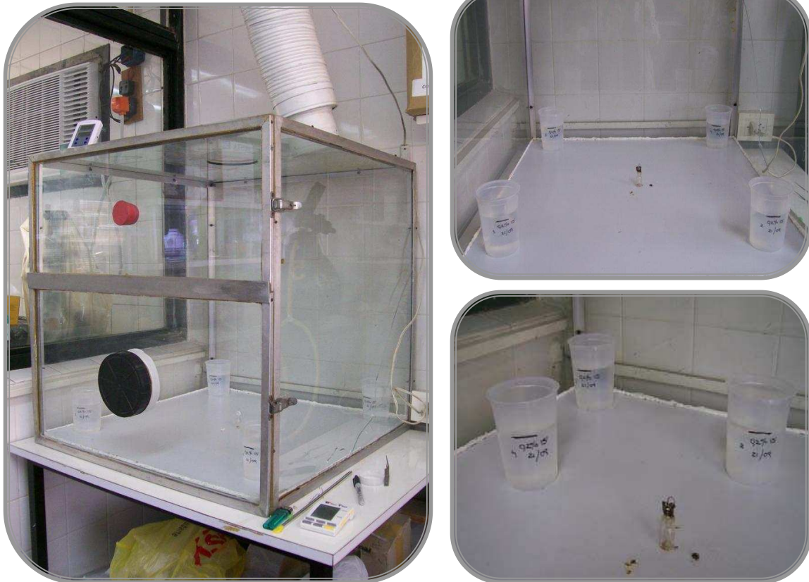
Figura 19. Cámara de vidrio tipo Peet Grady utilizada para los ensayos biológicos. Se muestra la disposición de los recipientes de plástico de 500 ml conteniendo larvas tardías del tercer estadio o tempranas del cuarto, colocados uno en cada esquina de la cámara.
