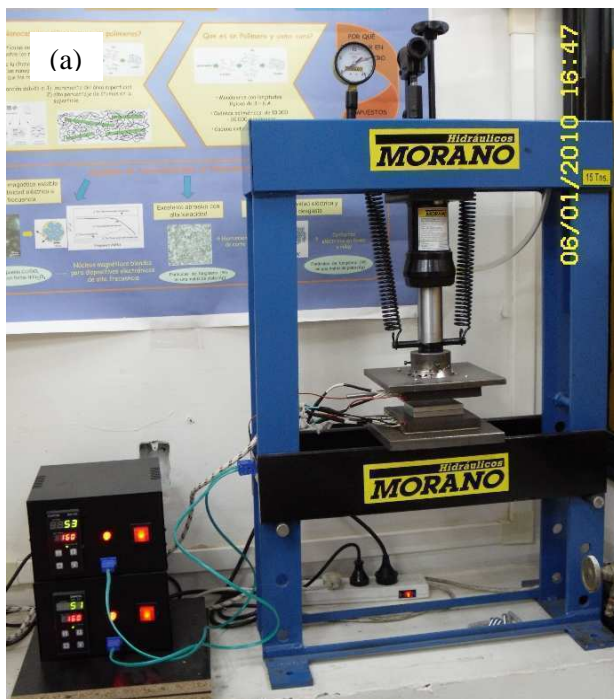
Figura 5.5: (a) Equipo utilizado para vulcanizar las muestras. (b) Detalle de la zona de calefacción del molde que contiene la muestra a vulcanizar.
