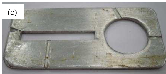
Figura 5.6: (a) Vista del molde de vulcanización cerrado. (b) Vista de la placa calada con la forma final de las muestras, la cual se encastra en la pieza inferior. (c) Detalle de la placa calada.
