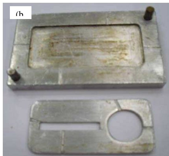
Figura 5.6: (a) Vista del molde de vulcanización cerrado. (b) Vista de la placa calada con la forma final de las muestras, la cual se encastra en la pieza inferior. (c) Detalle de la placa calada.
