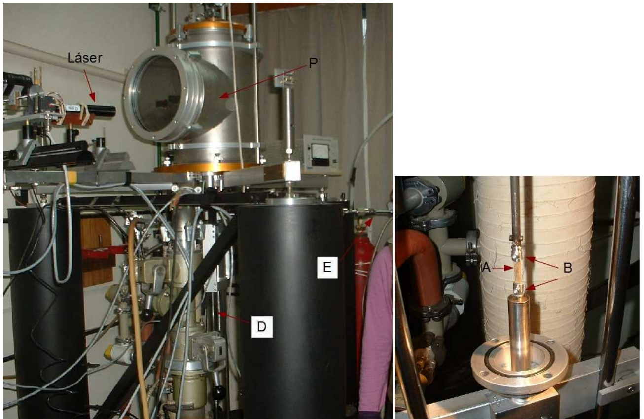
Figura 5.12: Péndulo de torsión de oscilaciones forzadas utilizado para las mediciones. Se indican algunos elementos con las referencias dadas en la Figura 5.12.
