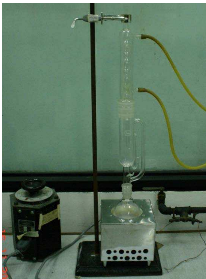
Figura A.3: Equipo de Soxhlet que se utiliza en el proceso de extracción de aceites del material.
