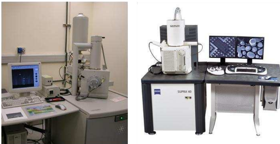
Figura 2.3:a. SEM Quanta 200 (FEI Company) (Laboratorio de materiales, CAC, CNEA). b. FESEM Supra 40 (Zeiss Company). (Centro de Microscopías Avanzadas, FCEyN, UBA)
