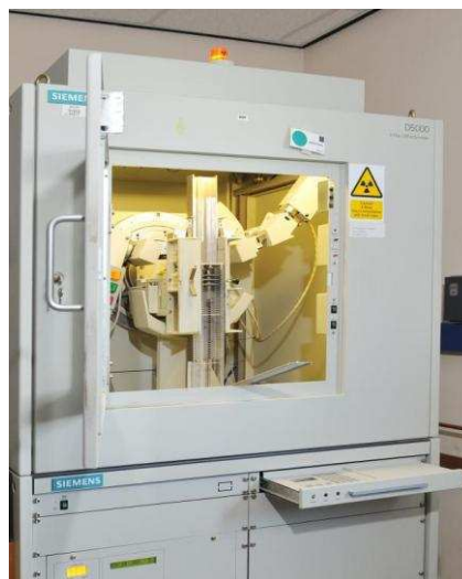
Figura 2.1: Difractómetro de rayos X SIEMENS D-5000. (INQUIMAE, Laboratorio de Sólidos y Superficies Inorgánicas)
