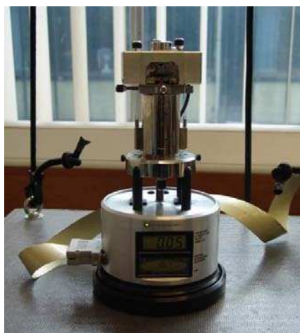
Figura 2.4: Microscopio de Fuerza Atómica Multimode Nanoscope IIIa. (CAC, CNEA)
