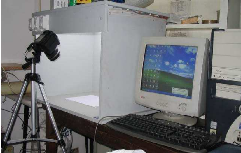
Figura III-8. Sistema de visión computarizada para la adquisición de imágenes.
