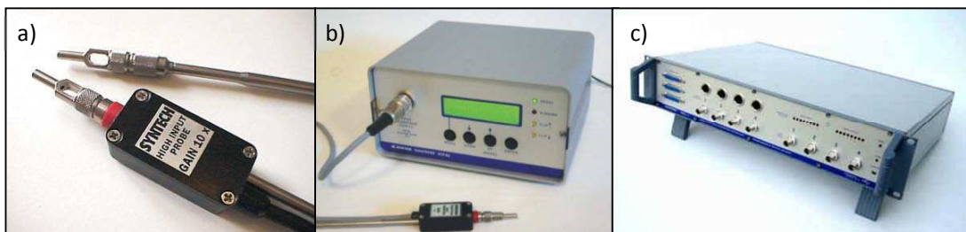
Figura 5.2. a) Soportes para electrodo de referencia y electrodo activo. Éste último, provisto de un pre-amplificador de la señal. b) Conexión del electrodo activo al equipo de registro de señales TastePROBE DTP-02. c) Amplificador y filtro IDAC 4.
