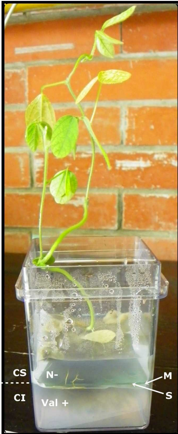
Figura III-1. Dispositivo utilizado para el ensayo de translocación de Nitrógeno. Los compartimentos superior (CS) e inferior (CI), se encuentran separados por una maya (M) que impide el paso de la raíz, y un soporte (S) de polipropileno.
