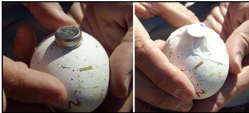
Figura 3.1. Izquierda, sensor de temperatura iButton colocado sobre los huevos de Pingüino de Magallanes; derecha, sensor adherido a través de la cinta adhesiva médica. El sensor tiene un tamaño de 17.35 x 5.89 mm.
