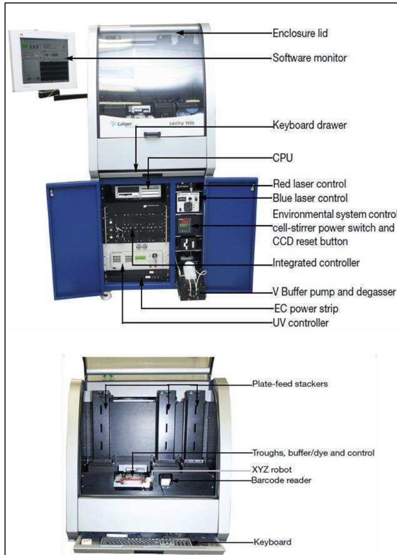
Figura M-5. LabChip 3000 Screening System con los elementos primarios detallados
