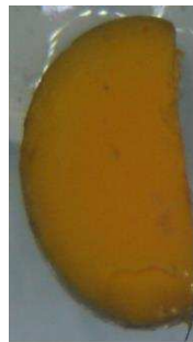
Figura 5.7 Aspecto del interior del catalizador B1 luego del ensayo realizado en ausencia de H 2 O 2 a T=323K.
