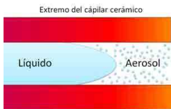
Figura I.1.- esquema de generación de aerosol por vía térmica
