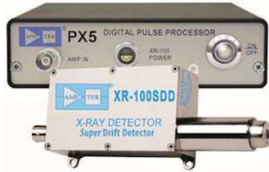
Figura 5.2: Fotografía del detector XR-100SDD y su electrónica asociada.
