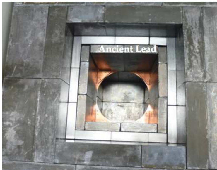
Figura 3.11: Fotografía de la parte interior del blindaje formado por el castillo de plomo. La capa más cercana al centro está formada por ladrillos de plomo recuperados de un galeón hundido siglos atrás, seguida por capas de plomo comercial.
